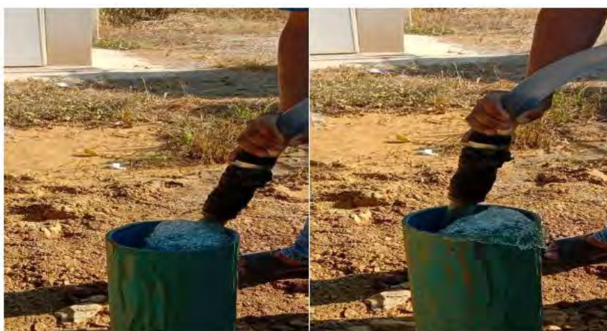
รูปที่ 34 ขณะน้ำกำลังจะเต็มเพื่อทดสอบ Slug Test ในหลุมทดสอบ DHW-1
