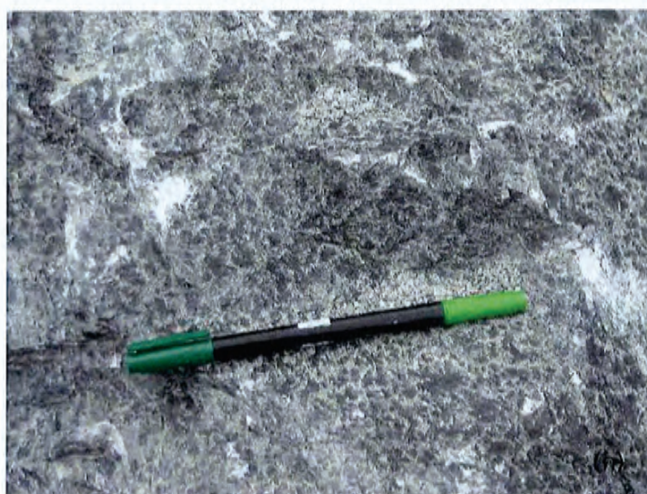
รูปที่ 3-9 ลักษณะของหินปูนสีเทาดำและเนื้อหินปูนบริเวณภายในบ่อเหมืองที่ 1
